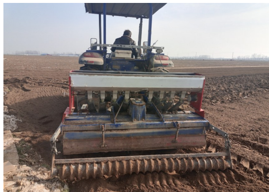
图2 旋耕、底肥撒施一体化
